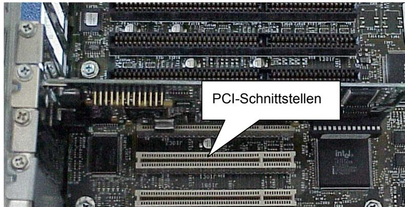
4. Bauen Sie die Karte in die PCI-Schnittstelle ein. Dabei muss das Slotblech zum Gehäuse zeigen. Drücken Sie zuerst die dem Rechnergehäuse abgewandte Seite vorsichtig in die Schnittstelle, dann die dem Gehäuse zugewandte Seite.
