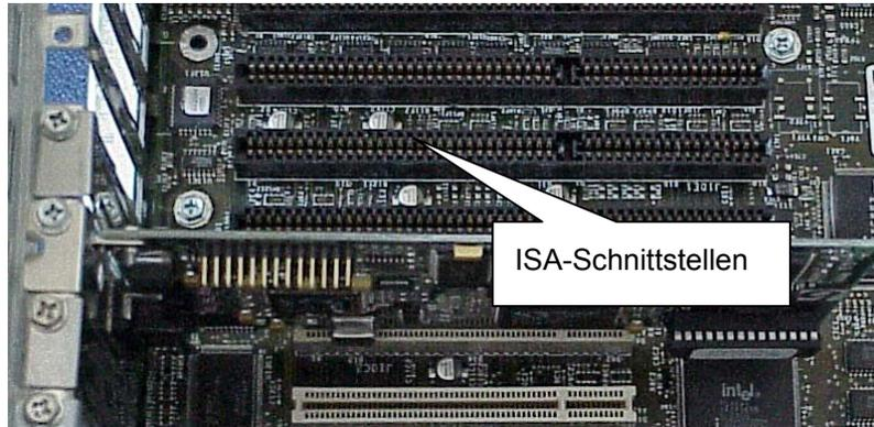
4. Bauen Sie die Karte in eine ISA-Schnittstelle ein. Drücken Sie zuerst die dem Rechnergehäuse abgewandte Seite vorsichtig in die Schnittstelle, dann die dem Gehäuse zugewandte Seite.
