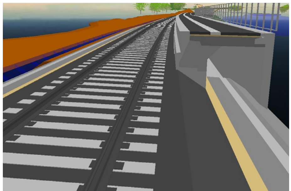
Abb. 3: Räumliche Darstellung eines modellierten Bahnkörpers und Bahnsteigs
